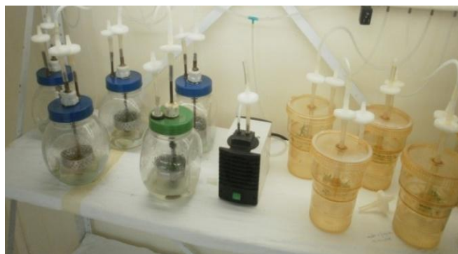
Figura 9. Detalle del envase y los cinco envases componentes del sistema de inmersión temporal artesanal diseñado y construido e instalado junto al sistema RITA®.
